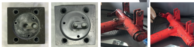
Teile vor und nach der Reinigung mit der Glogar Teile-Waschanlage
