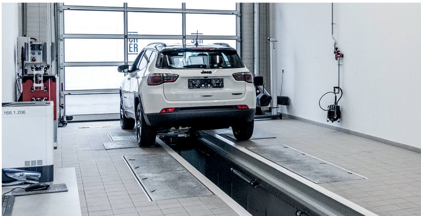
Achsmessgrube mit Schiebeplatten, Drehteller und Gelenkspietester
