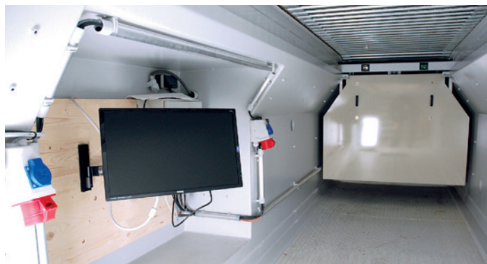
Optional: Bildschirm zur Anzeige der Prüfergebnisse in der Grube
