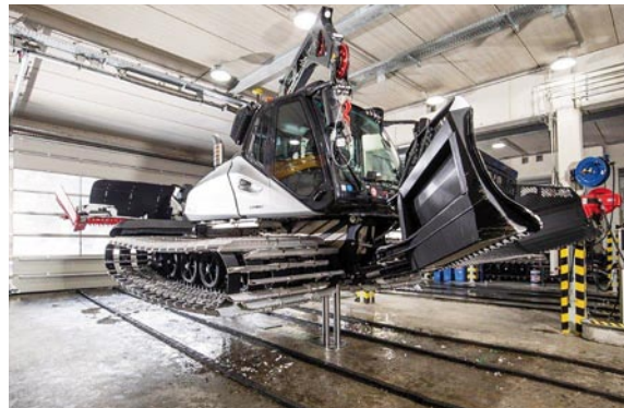
Speziell angepasste Lastaufnahmen ermöglichen das Anheben der Fahrzeuge zwischen den Ketten.
