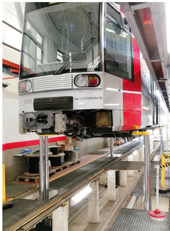
Über Laufschienen geführte Hebebockanlagen sind die perfekte Ergänzung für jede Arbeitsgrube.
