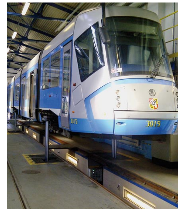
Zusätzlich zu den Hubzylindern bietet dieses Konzept eine individuelle und mitfahrende Drehgestell-Absturzicherung.
