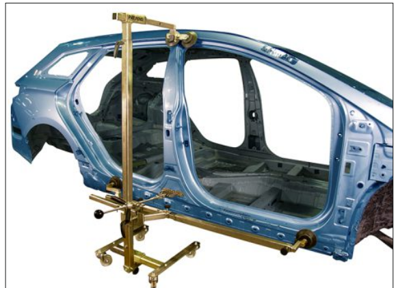
Richtvorgang am Seitenschweller
