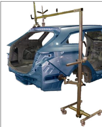
Richtvorgang an der Dachstruktur
