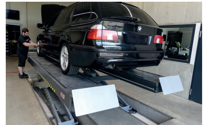
Pluspunkte für die Ravaliogli Scherenhebebühne gibt es von Fahrzeugtechniker Martin Wasinger, denn mit Spur- und Achsvermessung sowie Gelenkspieltester stellt sie die maßgeschneiderte Ausstattung für die Prüfung nach § 57a dar
