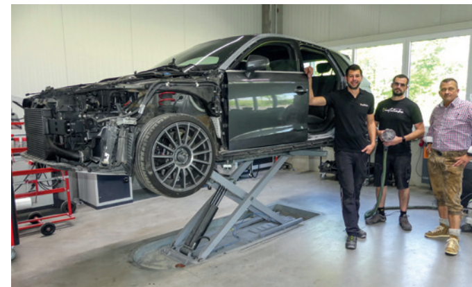
Praktische Car-O-liner Speed mit einem integrierten Zuggerät, womit man am auf der Bühne aufgespannten Fahrzeug Arbeiten fortsetzen kann, ohne es für weitere Arbeitsschritte absetzen müssen. Spart Zeit und Energie
