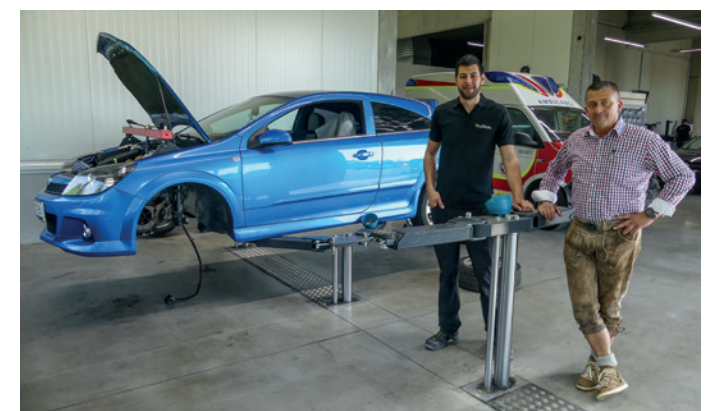
(o.) Autobedarf Kastner war auch bei der Planung des neuen Kfz-Betriebs von Anfang an dabei und so wurden die Hebebühnen perfekt integriert, wie man auch an den beiden in den Werkstattboden versenkbaren Schwenkarmbühnen von Becker sieht
